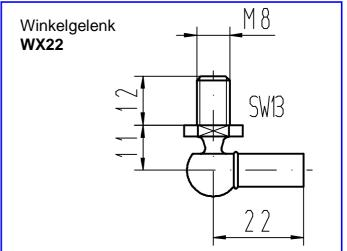
Die Gesamtlänge GL der Gasfeder setzt sich zusammen aus der Baulänge L der Gasfeder und der Summe der Einzellängen der Anbauteile.
